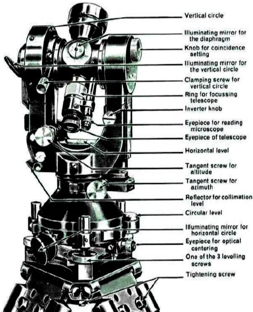
Fig. Vernier Theodolite
